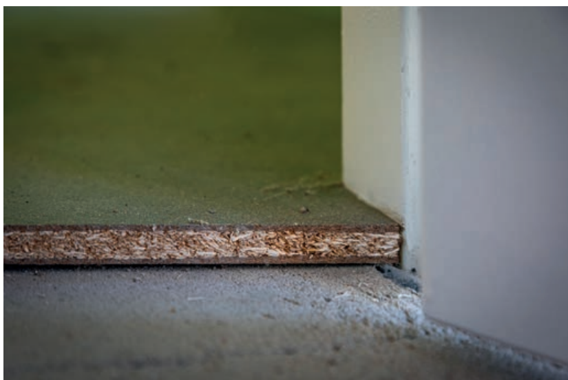
Bij het biocomposiet plaatmateriaal is een combinatie toegepast van circulaire bioharsen en hennep.
